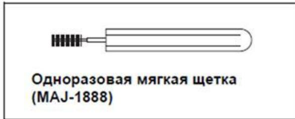
Щетка для очистки элеватора подъемка щипцов для доуденоскопов OLYMPUS TJF-Q180V
